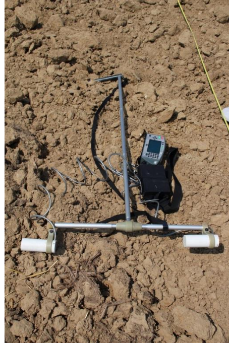
Magnétomètre Mesure la variation du champs magnétique induit par le tuyau
